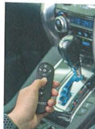
調光&調色の各操作は、付属のリモコンで行う。+/-ボタン操作で調光、UP/DOWNボタンで調色の操作がそれぞれ可能。電源ボタンを押すことで光をオフにできる。
