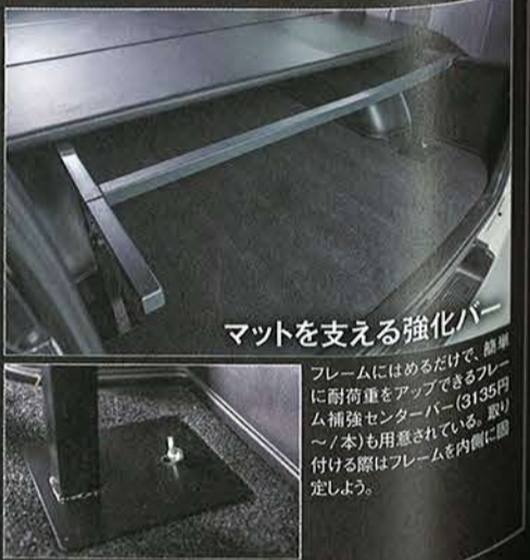
高さの変更は、フレームに開けられた穴の差し込み位置を変えるだけでOK。ヘッドは高さ調整機能が付いているのも嬉しいポイント。例えばヘッドを限界まで上げれば下のスペースに余裕がで、より多くの荷物を積める。
