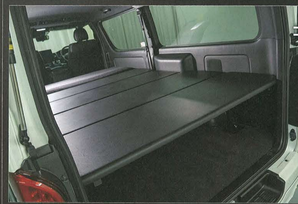
高さの変更は、フレームに開けられた穴の差し込み位置を変えるだけでOK。ヘッドは高さ調整機能が付いているのも嬉しいポイント。例えばヘッドを限界まで上げれば下のスペースに余裕がで、より多くの荷物を積める。
