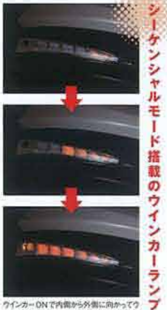
ウインカーONで内側から外側に向けてウインカーの光が流れるシーケンシャル機能を搭載。セパレートデザインのレンズ効果により綺麗に流れる光を演出する。
