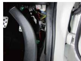
② 内張り剥がし等で持ち上げるように外して下さい。
