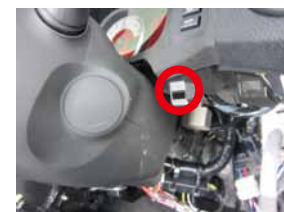
⑦ 内張り剥がし等でリレーを車両フレームから取り外して下さい。
