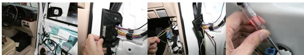
◆ドアミラーを車両へ取付け、配線を車内へ引き込みます。配線ガイドなどを使用して下さい。
