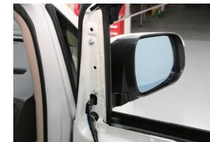
◆電動格納のコネクタを外し、ドアミラー本体を固定しているビスを外します。外す際にはドアミラー本体が落下しないよう注意して取り外して下さい。
