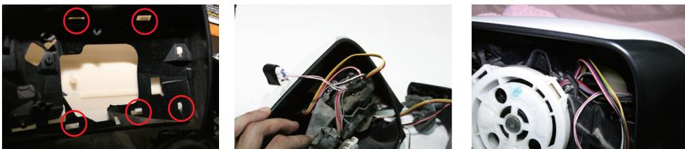
◆上記写真は一部分ですが、爪が多いため、必要に応じてモーターをずらして爪を外して下さい。
