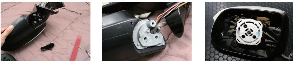
◆根元のカバーを取り外し、中のボルトを外して下さい。ドアミラー土台部分とカバー(モーター部分)を分解していきます。モーターとカバーを分離させたらカバーのツメを確認してカバーを外して下さい。
