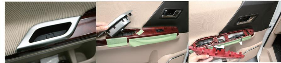
◆ドアの内張りを外すため、ウィンドウスイッチパネルを外します。まず後方のポケット部分の底にネジがある場合はネジを外し、ドアノブのネジも外します。次にスイッチパネルを斜め後ろ方に持ち上げて外し、スイッチのコネクタも抜きます。
