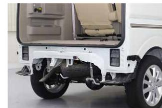
■上記のボルト・クリップを取り外したらリアバンパーを取外していきます。少し浮かせた状態でテールランプハーネスを外します
