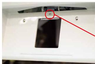
■赤丸の部分に穴を開け、長ボルトを使ってパネルを固定します
