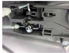
④ワイヤーを手前上部に持ち上げ金属部をドアロック部分から取り外して下さい。
