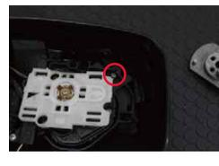
⑬モーターを固定しているボルトを取り外します。
