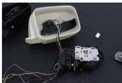
⑮製品を用意し、モーターの配線が通っている箇所へ一緒に配線を通していきます。
