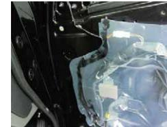
②ドア内部のスピーカー上保護ビニールを剥がしていきます。**プチルが使用されていますので周囲付着に注意して下さい。**
