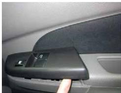
④スイッチ部を内張り剥がし等で上部へ持ち上げ取り外して下さい。
