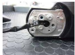
⑪プレートのトルクスボルトも外します。
