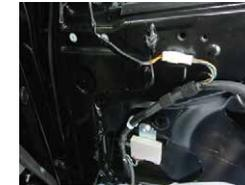
③スピーカー上部のドアミラーカブラーを取り外して下さい。
