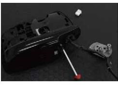
⑫プレートを外し、中のボルトも取り外します。
