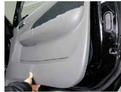
④クリップを外したらドアパネルを上部へ持ち上げドアから外して下さい。
