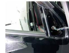
③ドアミラー本体を引き配線をドア内部より引き出して下さい。
