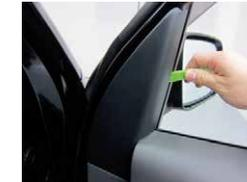
②内張り剥がし等で上部方向へ持ち上げ取り外して下さい。
