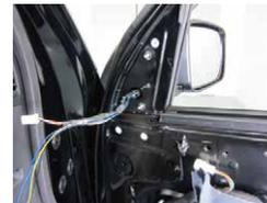
①ドアミラー本体を取外し手順の逆で取付けを行って下さい。
