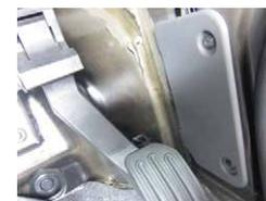
⑧ネジ2本を取り外し、カバーを外して下さい。外したらドア内部より室内へ配線を通して下さい。
