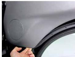
③隙間ができたなら内張りを手で写真のように内張り裏クリップを剥がして下さい。
