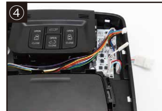
④ 小さい基盤はこのように設置します。 ※見やすくするためにレンズ部分は取り外しています。
