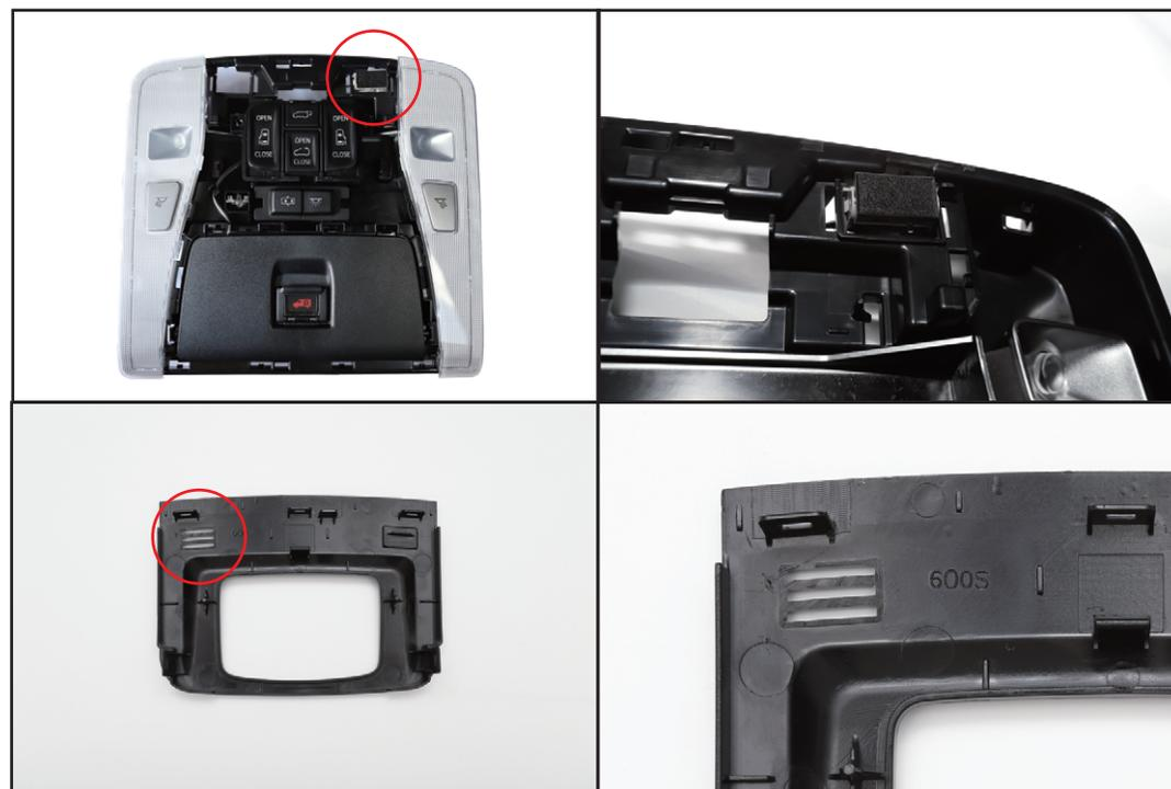
左写真：赤丸の位置にナビ用のマイクなどが装着されている場合、左下写真の赤丸の部分のように製品側スイッチパネルの裏側を削ってください。
