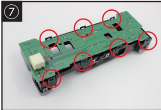
⑦ 基盤・Door 運動スイッチの取外し方法
