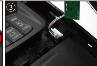
③ 赤い丸のところへ右図のようにコネクタを通します。
