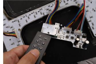
③赤いランプが点灯している間にリモコンのボタンを押し、赤いランプが消灯したらペアリング設定完了です。
