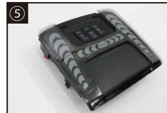
⑤ ルームランプユニットを取付します 配線はパネル側の爪が干渉しない位置へ避けて取付してください。 →純正 LED ルームランプの場合は純正コネクタへ接続して作業完了です。 →純正ハロゲンルームランプの場合は次ページ QR コードから見れる WEB 上の作業説明書の配線接続をして作業完了です。
