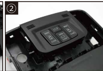
② 製品を用意します。先に製品のスイッチパネルとスライドドアスイッチ部分を取り付けます
