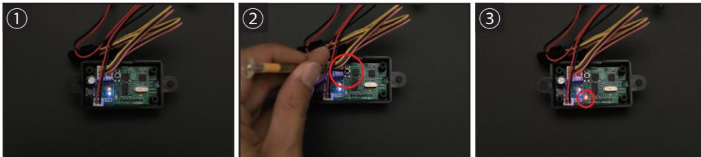
①ワイヤレスリモコン受信機のカバーを開けた状態です。(電源供給されている状態です) ②赤い○の部分のスイッチを3秒押し続けます。 ③赤いランプが点灯します。
