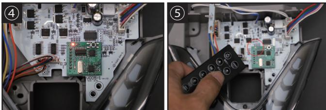
④赤いランプが点灯します。 ⑤赤いランプが点灯している間にルームランプを操作するボタンをどれか一つ押してください。赤いランプが消灯すればペアリング設定完了です。
