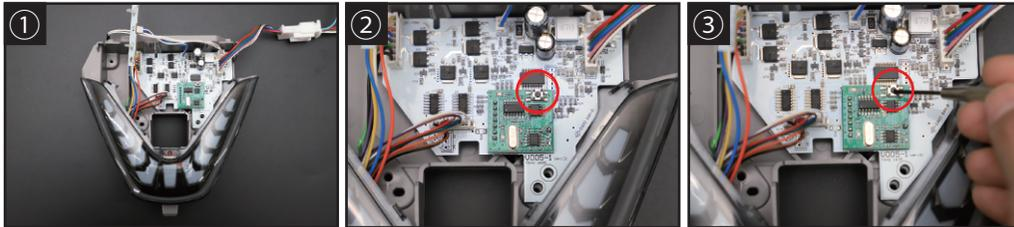
①黒いパネルを取り外した状態です。(電源供給されている状態です) ②赤い○の部分にスイッチがあります。 ③スイッチを約3秒押し続けてください。
