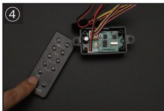
④【DAYLAMP】もしくは【FLOW】のボタンを押してください。赤いランプが消灯すればペアリング設定完了です。
