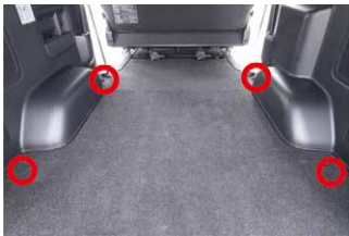
赤○のタイダウンフックを取り外します。
