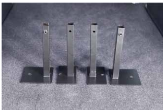
スリーブを置いた上へ穴の位置を合わせて土台フレームを設置します。幅の狭いほうが車両前方側、幅の広いほうが車両後方側です。
