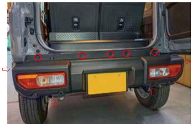
赤○のボルト、クリップと、赤矢印の位置（リアタイヤ側左右1本ずつ・下側左右1本ずつ）のボルトを
