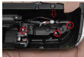
①赤矢印のカプラーを取外し、赤○のナットを取り外します。
