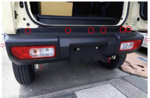
赤○のボルト、クリップと、赤矢印の位置(リアタイヤ側左右1本ずつ・下側左右1本ずつ)のボルトを取外してリアバンパーを取り外します。助手席側テールランプ裏側にコネクタがあるので取り外します。
