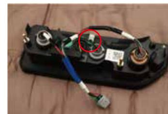
⑥赤○の部分のビスを取外し、配線を白い部品の輪へ通して固定させます。
