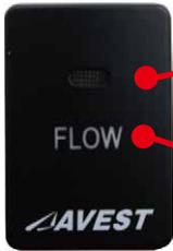
インジケータの点灯タイミングは、ドアミラーウインカーレンズ側の【**緑 / 赤 / 黒**】の**緑線・赤線**と同期します。この2本の線に電力がきていない場合スイッチを ON にしてもインジケータは点灯しませんのでご注意ください。
