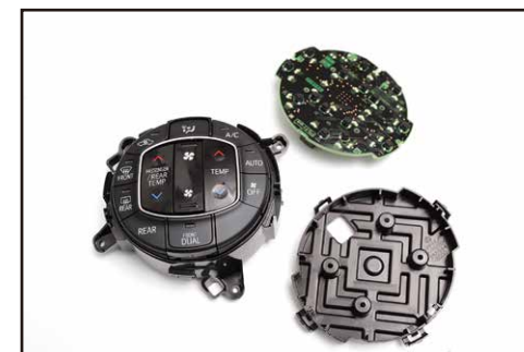
④カバーを固定しているツメを外して分解します。
