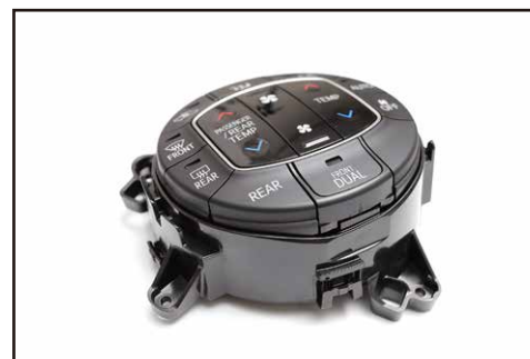
③エアコンパネルを取り外した状態です。
