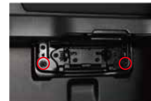
②サイドテーブルの天板下のボルト2箇所を取り外します。
