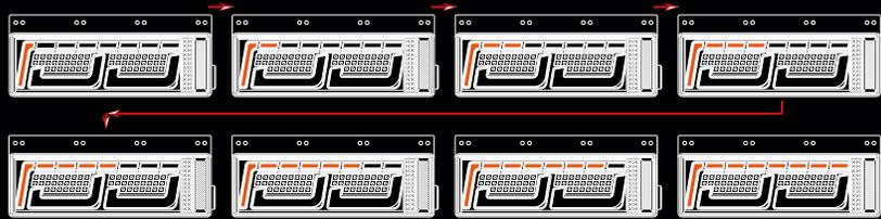
シーケンシャルモード搭載のウィンカーは車両内側から外側へ向かって流れるように点灯していきます。付属スイッチにてワンタッチで通常点滅モードへも切り替え可能!
