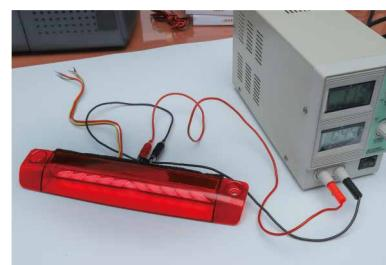
・取付後に初期不良であった場合でも弊社では取付工賃などの負担は一切承れませんので、必ず作業前に12Vの電流を流し、製品の点灯チェックを行って下さい。
