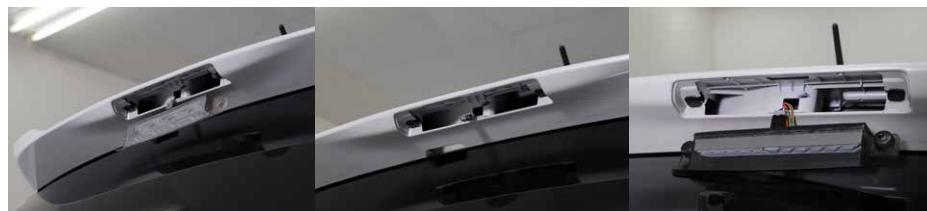
◆純正ハイマウントは左右のビスを外せば取り外せます。製品と入れ替え、配線を純正のカブラー配線が通っている場所へ一緒に通していきます。
