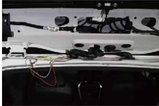
⑥ブレーキランプ側ハーネスをトランク内張りを通してリアゲートまで引き込みます。
