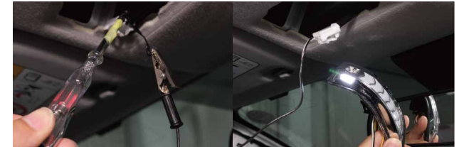
カプラーの部分にテスターを使い、ルームランププラス/マイナスの配線を探します。右図は端子を仮差しし、点灯確認を行っている画像です。
