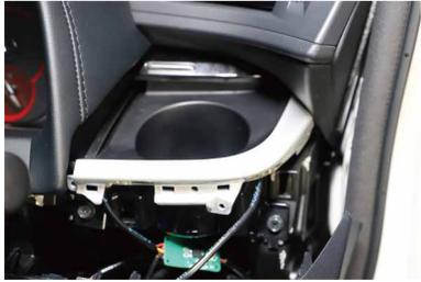
スタートスイッチ周りのパネルを取り外し、ドリンクホルダー部分のパネルを製品と交換してください。
