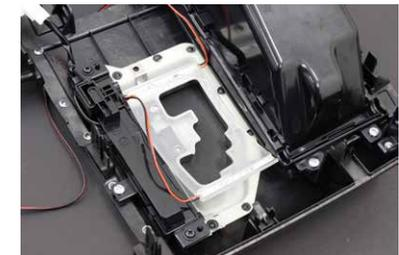
シフトパネル裏に製品を設置します。簡易的に粘着力の弱い両面テープ等でフチを固定すると車輻へ取付時に取り付けしやすくなります。
