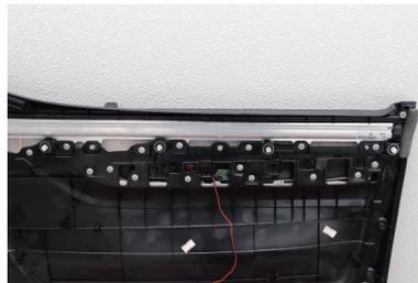
ドアパネルを取り外し、裏側のビスを取り外してオーナメントを取り外します。
