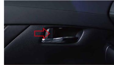
内張り剥がしなどを使い矢印の方向からパネルを取外してください。
