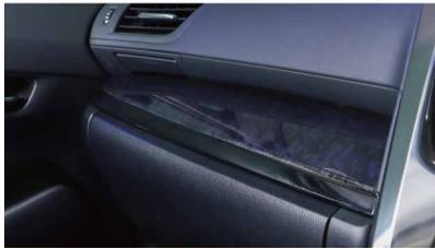
パネルを上部に持ち上げ取り外し、製品と交換します。
