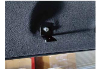
⑥L時の金具を図のように取り付けます。アシストグリップの部分は純正のボルトを使用できます。リア側のブラッシュクリップ部分は付属のボルトを使用してください。
