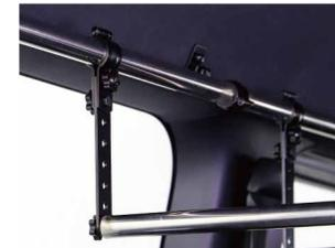
⑧上図のようにサイドバーへブラケットとステーを取り付けてクロスバーを取り付けます。このブラケットの位置で前後の調整ができます。お好みで調整して下さい。
