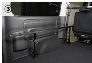
③ 門型フレームを図のように取り付けます。ダイヤルボルトでお好きな高さになるように固定してください。
