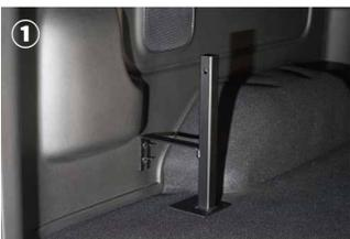
① ②ラゲッジルームのユーティリティナットへ土台フレームを取り付けます。付属の蝶ネジとワッシャーを使用してください。
