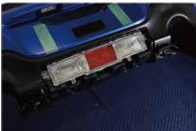
・リアフォグ左右のボルトを取外してリアフォグを取り外します。
