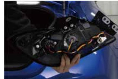
・テールランプを手前側に引くと外れます。カブラーを取外してテールランプ本体を取り外します。
