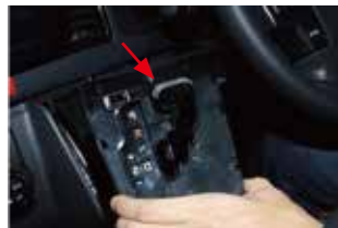
⑬補助的に矢印部分に両面テープをつけておくと作業し易くなります。
