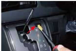
⑨シフトロックカバーを取外し、ギアをニュートラルにします。
