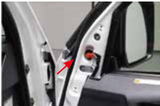
⑥内張り上部の三角パネルを取り外します。
