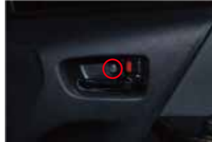
⑤ドアハンドル内のネジを取り外します。
