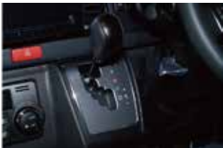
⑧シフトパネルを取り外します。
