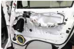
⑦内張りを取り外します。ページ1の配線説明を参考に配線接続をしてください。助手席側も同様に作業します。
