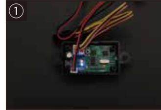
①ワイヤレスリモコン受信機のカバーを開けた状態です。（電源供給されている状態です）
