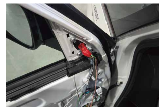
⑭外したカバーを元に戻してドアミラーを車輪へ取り付けていきます。
