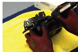
⑩超音波カッターなどを使って左図の赤い部分をカットしてください。
