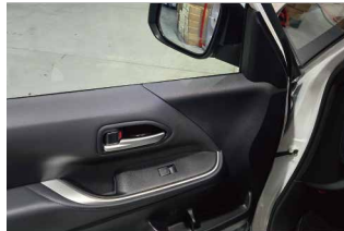
②ウインドウスイッチ・ドアハンドル内・ドアトリム上部のカバーを外します。
