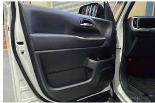
①ドアの内張りを外していきます。
