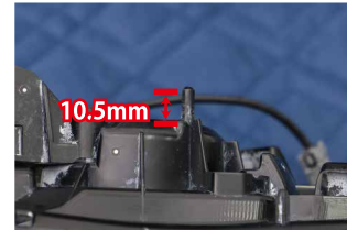
⑪画像部分の突起を根元から10.5mmの高さになるように先端をカットします。
