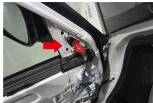
⑤3つのナットを取外し、ドアミラーを取外します。
