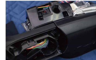
⑬モーター配線が通っている箇所へ製品の配線を通していきます。
