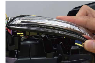
⑫製品のウインカーレンズ裏の筒の部分と、⑪で削った突起を合わせてセットします。
