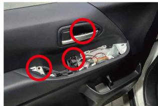
③赤○3箇所ボルトを取り外してドアの内張りを外します。
