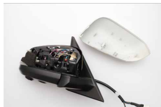
⑦ミラーレンズを外し、内側から爪を押してカバーを外します。
