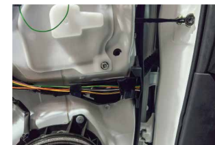
⑮製品に付属している延長配線を用意し、車内へ配線を通していきます。
