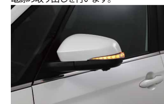
⑲点灯確認をし、問題がないようでしたら外したパネル類を元に戻して作業終了です
