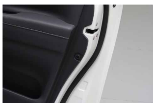
⑤パネルサイドのボルトも取り外します
