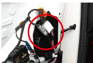
⑧赤○のコンネクター2つを取り外し、黒いパネルも取外します。
