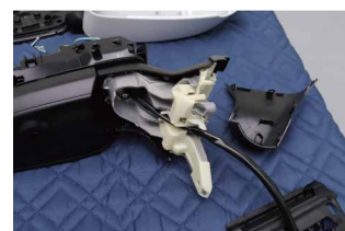
⑭ASSY根元のカバーを取り外します。
