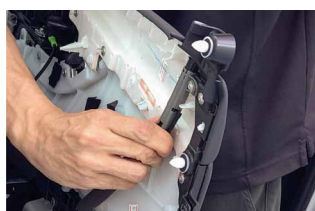
⑦ドアロックをパネル裏側から取り外します。ドアハンドルのワイヤーも取外します。
