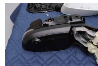
⑮下部の黒いカバーを取り外します。モニター類のコンネクターも取り外します。
