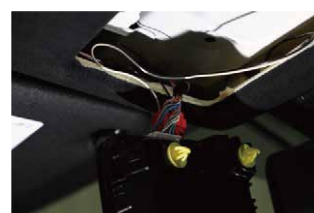
⑰フットランプ配線がルームランプユニット裏のカバーから電源を取り出します。
