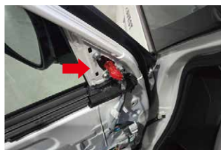
⑤3つのナットを取外し、ドアミラーを取り外します。
