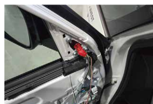
⑭外したカバーを元に戻してドアミラーを車輛へ取り付けしていきます。
