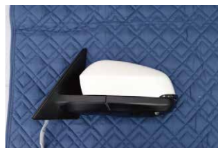
⑥ドアミラーカバーを取外します。
