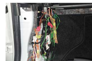
⑯助手席キックパネル内から延長配線を引き込み、ページ1の配線説明を参考に電源の取り出しを行います。
