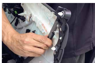
⑦ドアロックをパネル裏側から取り外します。ドアハンドルのワイヤーも取外します。
