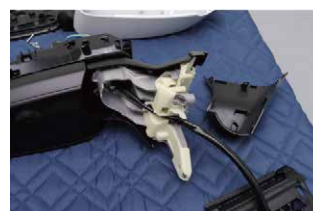
⑭ASSY根元のカバーを取り外します。
