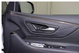
②ウインドウスイッチ・ドアハンドル内・ドアポケット・ドアトリム上部のカバーを外します。
