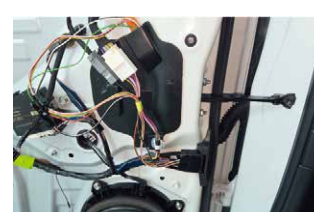
④製品のウinkerレンズからの配線と 延長配線を接続します。 ※必ず色を合わせて接続してください。 ※端子の差し込み不良による点灯不具合 のないようご注意ください。
