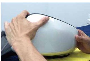
㉔外したカバー類レンズを元に戻します。
