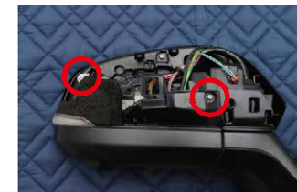
③赤○2箇所のボルトを取り外します
