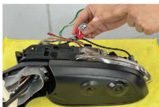
㉒純正ウinkerレンズカバーを防水処理してください。 ※ウinker電源はこちらの配線からも分岐して取ることが可能です。
