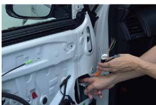
㉕ドアパネルヘッドミラー ASSY を取り付け、配線を引き込みます。
