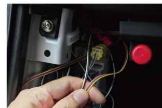
②車内へ引き込んだらページ 1 の配線説明内を参照し各電源を接続します。 スイッチもハーネスを接続し、設置していきます。
