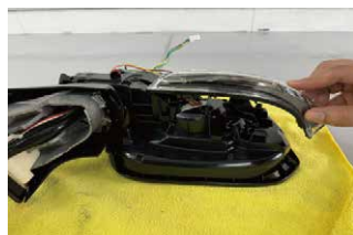
⑳製品のウinkerレンズ裏の筒の部分と、⑲で削った突起を合わせてセットします。
