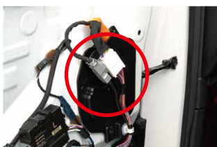
⑧赤○のコネクタ2つを取り外し、黒いパネルも取外します。
