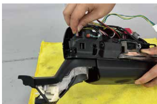
㉓ミラーモーターなどの配線が通っている穴へ製品の配線を通します。
