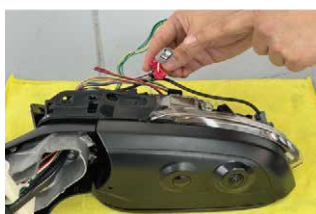
㉓純正ウinkerレンズカプラーを防水処理してください。 ※ウinker電源はこちらの配線からも分岐して取ることが可能です。
