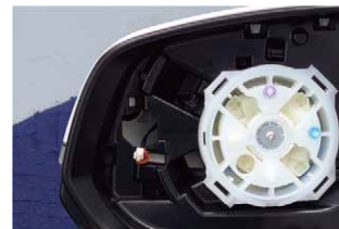
⑫内側から爪を外してカバーを取り外します。
