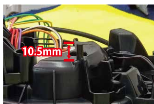
⑲赤○の突起を根元から 10.5mm の高さになるようにカットします。 ※ カットしすぎないようにご注意ください。
