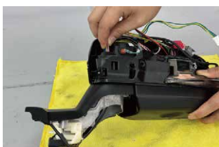
㉔ミラーモーターなどの配線が通っている穴へ製品の配線を通します。
