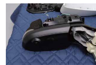
⑮下部の黒いカバーを取り外します。モニター類のコネクタも取り外します。
