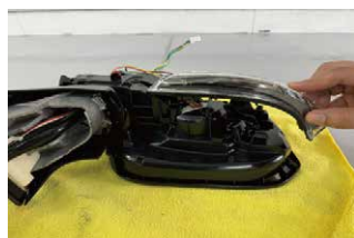
㉑製品のウinkerレンズ裏の筒の部分と、⑲で削った突起を合わせてセットします。
