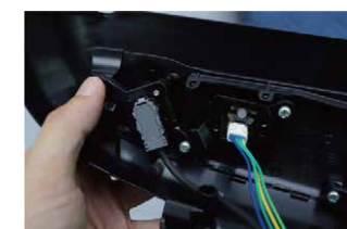
⑮下部の黒いカバーを取り外します。モニター類のコネクタも取り外します。
