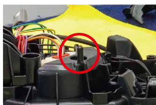
⑲赤○の突起を根元から 10.5mm の高さになるようにカットします。 ※ カットしすぎないようにご注意ください。
