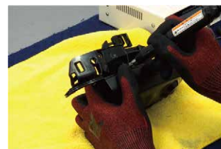
⑰超音波カッターなどを使って右図の赤い部分をカットしてください。
