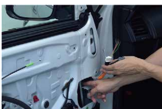
㉖ドアパネルヘッドミラー ASSY を取り付け、配線を引き込みます。
