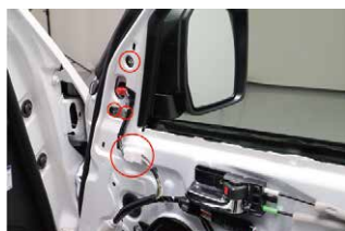
⑧赤○のコネクタとナット3個を取り外します。
