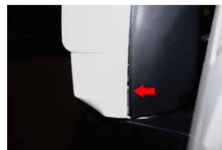
★注意：はめ込みが不十分だと、車体側が左画像のように浮く場合がございます。強めに押し込んでツメが「パチッ」となるまで押し込んでください。しっかりと押し込まれると右画像のようになります。
