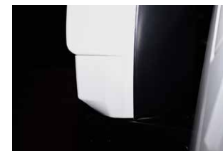
★注意：はめ込みが不十分だと、車体側が左画像のように浮く場合がございます。強めに押し込んでツメが「パチッ」となるまで押し込んでください。しっかりと押し込まれると右画像のようになります。
