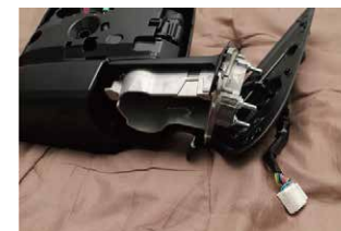
⑭製品の配線を通しやすくするため、下部のカバーも取り外します。
