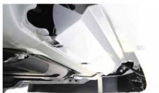
③バンパー下側のクリップも取り外します。
