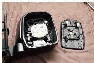
⑧赤○のコネクタとナット3個を取り外します。
