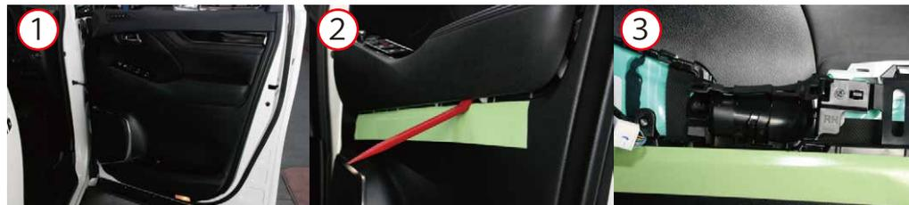
1～3：ドアウインドウを下げ、ドアの内張りを外します。ドアハンドルの中のネジ、ウインドウスイッチ周辺の内張りを固定しているネジを取り外してから内張りを剥がして下さい。スイッチパネルとドアハンドル内の固定ねじを外して内張りを外します。
