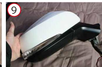
7～9：下部カバーの下側の爪の写真です。この部分にレンズをはめ込み、レンズ上部の爪を合わせて取り付けます。配線を適度に残しドアミラー内部で配線が邪魔にならないように納めます。上下のカバーを取り付けし、元の手順でドアミラーを車両に取り付けます。
