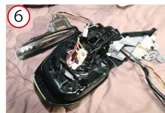
6：製品を用意し、配線をモーターから出ている配線が通っている穴へ通します。
