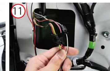
←延長配線は長さ違いますので、配線接続箇所を決めた後に配線の長さを確認し、左右それぞれ合った延長配線を使用して下さい。
