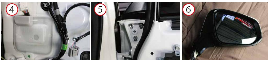
4・5：4の白いカバーを外し、ドアミラーウインカーから伸びている配線カプラーを外します。5でドアミラーASSYを固定しているネジを外します。
