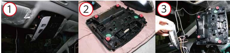
← 3の写真はドアミラーレンズ取付前に製品の配線端子をルームランプユニットのカブラー部分へ差し込み点灯確認している写真です。
