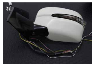
⑫取り外しの逆の手順で組み立ててください。特に根元部分を組み立てる際は配線を挟まないようご注意ください。
