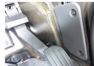
⑦～⑧：ネジ2本を取り外し、カバーを外して下さい。外したらドア内部より室内へ配線を通して下さい。
