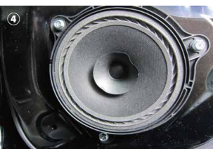
④～⑤スピーカーネジ3本を取り外して下さい。
