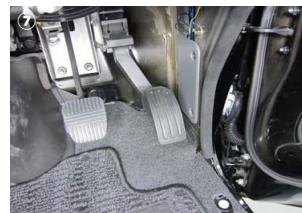
⑦～⑧：ネジ2本を取り外し、カバーを外して下さい。外したらドア内部より室内へ配線を通して下さい。
