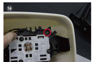
⑩～⑪モーターの固定ビスの取付
