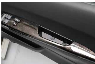
②ポケット内のボルトを取り外します。
