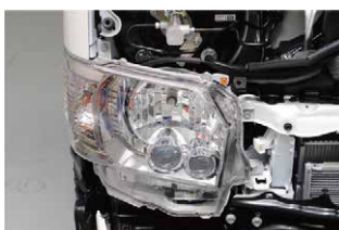
⑧ヘッドライト横のボルトを取外し、ヘッドライト本体を取り外します。
