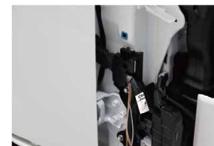
⑫配線を通していくと、⑨で外した部分から配線が出てきます。
