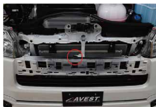
⑤シルバーのグリル部分を取り外します。グリルが外れたら赤○部分のクリップを取り外します。
