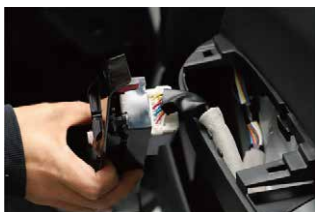
⑤ウインドスイッチパネルを取り外し、コネクタも取り外します。
