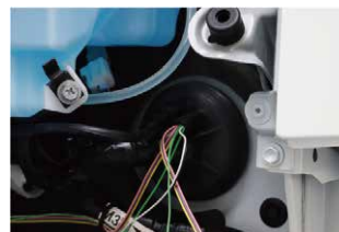
⑭オプションランプ用の配線と、フットランプ用配線、スイッチ用配線をウォッシュタンク近くのゴムキャップ内へ通します。 ※画像は突起部分をカットして配線を入れています。
