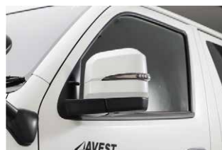
⑯配線を通したら、カバーをはめ込み、ドアミラーAssyをドアパネルへ取り付けます。
