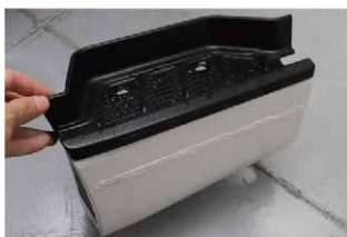
②運転席・助手席のステップを取り外します。上下のクリップを取外すとステップが外れます。
