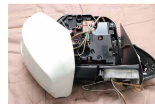
⑮製品を用意し、配線をミラーモーターが通っている箇所へ一緒になるよう通していきます。 ※ミラーを折りたたむときに配線が引っ張られないよう若干余裕を持たせてください。
