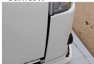
⑥左右のヘッドライト下側の画像です。ツメを外しながらバンパーを外していきます。
