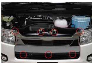
④赤○の部分のクリップとボルトを取り外します。
