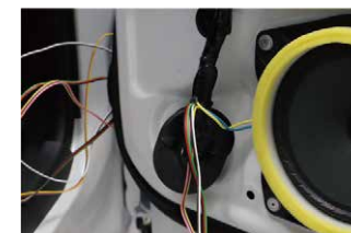
⑩付属の延長配線を用意し、スピーカー横のグロメットへ配線を通していきます。
