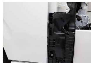
⑨バンパー両サイドの黒いコネクタカバーを取り外します。上下2本のボルトを外すと取り外せます。
