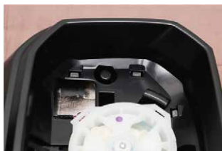
⑪ドアミラー内側からカバー裏のツメを押してカバーを取り外します。
