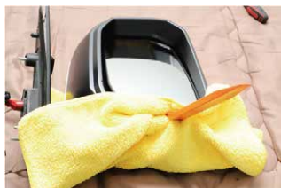
⑩ミラー上部を奥へ押し込み、下側から内張り剥がしなどを使ってミラーを取り外します。
