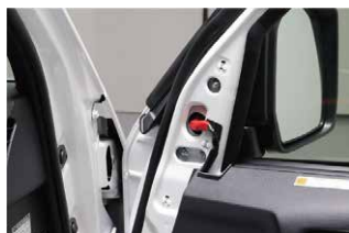
④ドアミラーAssy根元側のカバーを取り外します。
