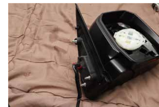
⑬ドアミラー Assy の根元側の黒いカバーを外します。
