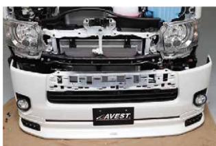
⑦少しずつ外しながら裏側のコネクタを外してバンパーを取り外します。
