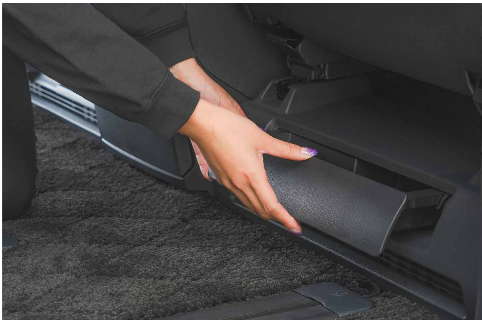
①2列目足元にある純正のスライドトレイ式収納を取り外します。
