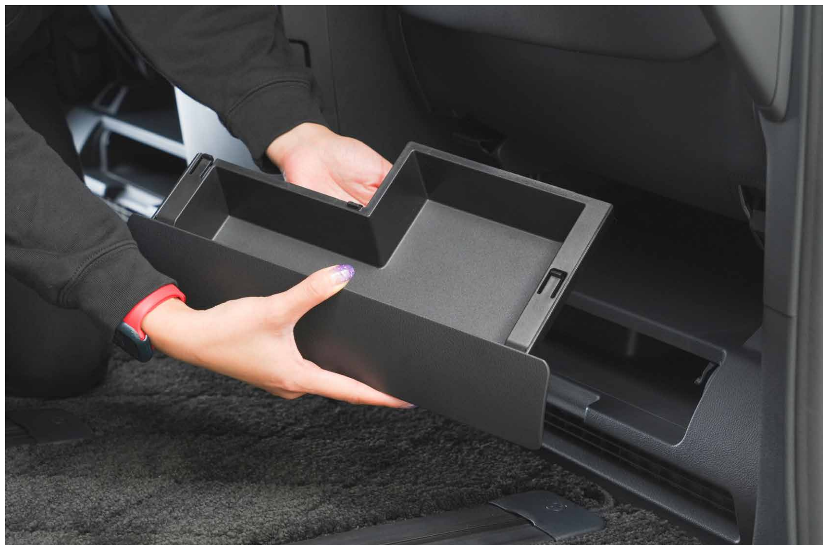
②爪を下に押しながら引くと外れます。
