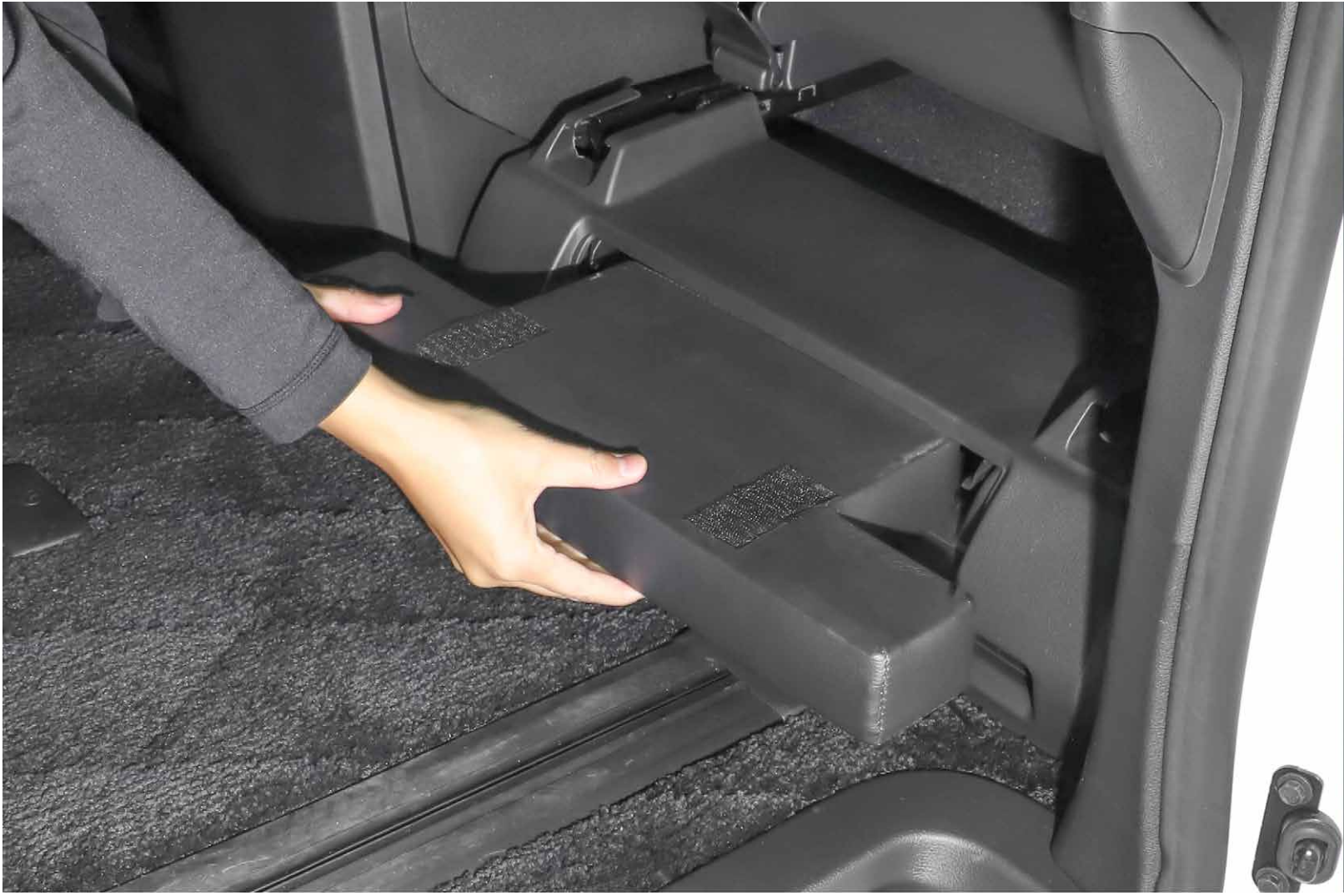
③ベース用脚を台に装着し、ベース部分を奥までしっかり差し込みます。
