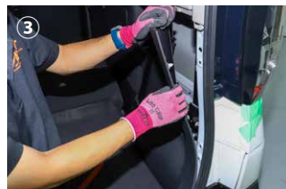
③ 内側のパネルを内張りはがし等を使ってテールレンズ裏のハーネスが見えるまで外します。
