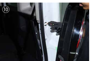
⑩ 製品のコネクタと配線を車体側の穴に通します。
