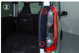
② 〇部分のボルト 2 本を取外します。
