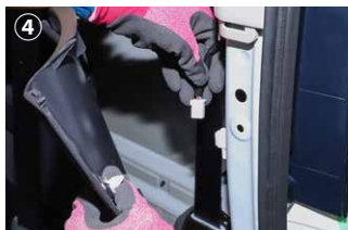
④ テールの裏側にあるコネクタを外します。
