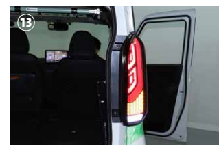
⑬ 再び点灯チェックをします。左右の点灯モードが揃っているか再度確認をしてください。
