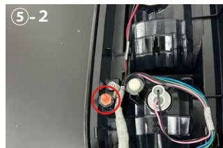
⑤-2 ※車両によっては取り外しにくく、〇部分のピンが折れやすい場合がありますのでご注意ください。
