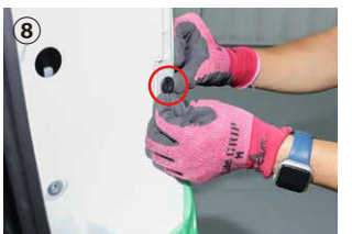
⑧ 車体側の〇の部分へ⑦で外した部品をはめ込みます。
