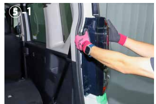
⑤-1 テールランプ上部を手前に引きます。上部のピンが外れた後テールランプ下部を引き取り外します。
